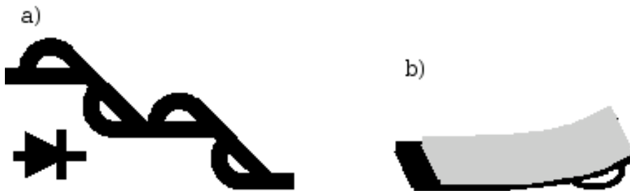
Abbildung 3: Darstellung a) einer fluidischen Tesla-Diode und b) eines aktiven Ventils mit piezoelektrischem Biegeaktor
