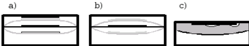
Abbildung 2: Membranpumpen nach dem a) elektrostatiscchen, b) dem piezoelektrischen und c) nach dem thermischen Prinzip
