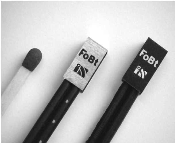
Abb.2 Faseroptischer Betauungssensor, links im Bild ein Streichholz als Maßstab.
